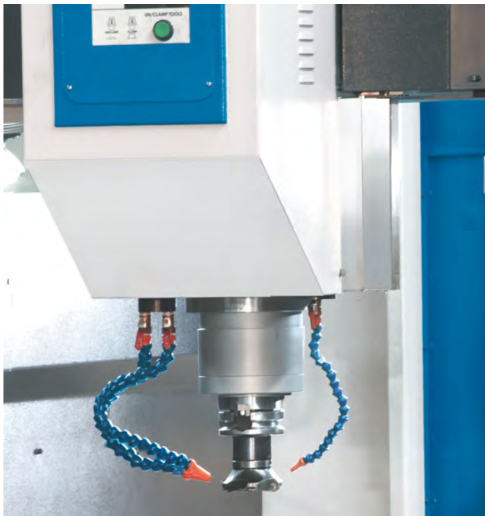
Зажим шпинделя с режущей головкой
