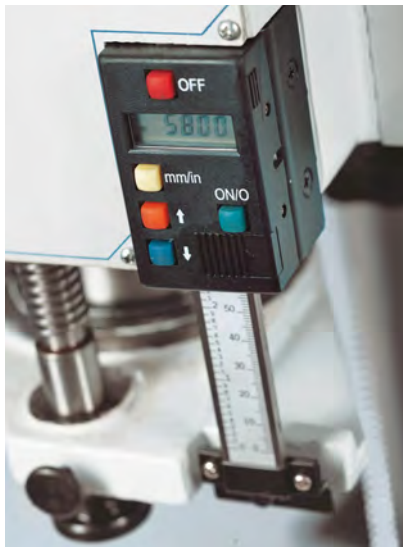
Цифровая индикация глубины сверления
