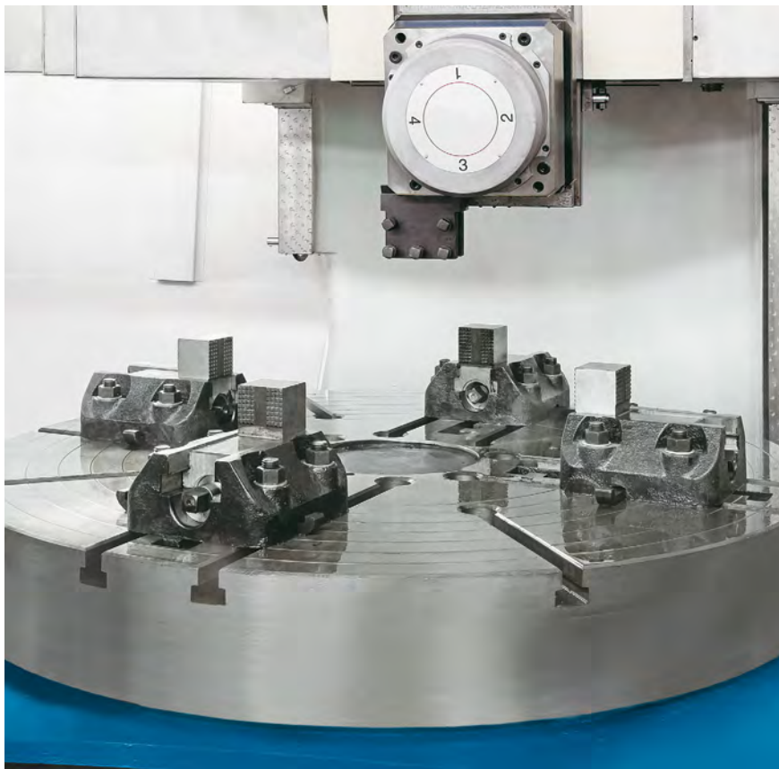
Круглый зажимной стол с 4-позиционным сменщиком инструмента
