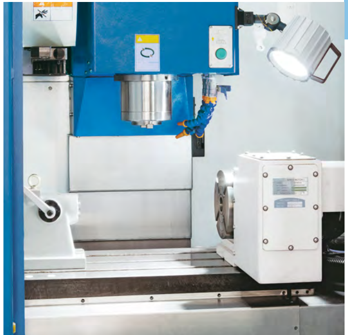
Стандартная комплектация ручной задней бабкой
