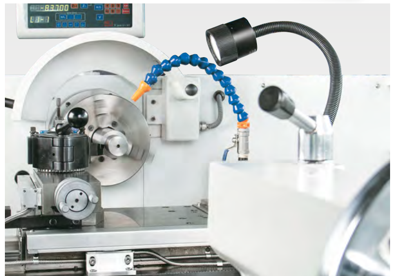
Поперечные салазки с механической подачей и поворотом
