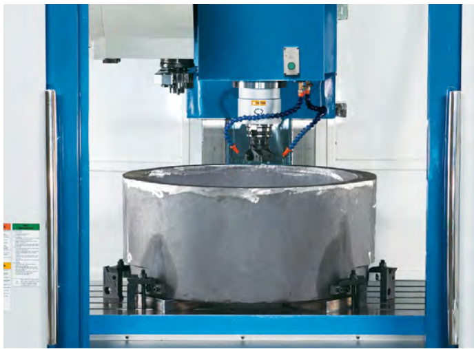
Высокая допустимая нагрузка стола, макс 1500 кг (X.mill 1500)
