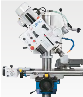
Поворотная фрезер. головка (л/пр) Рабочий стол регулир. по вертикали
