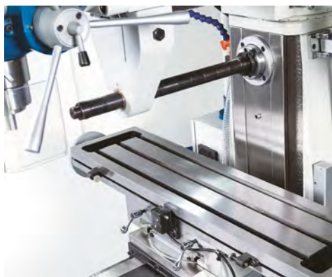
Верхняя траверса, оснащенная серьгой, позволяет надежно зажимать длинные фрезерные оправки
