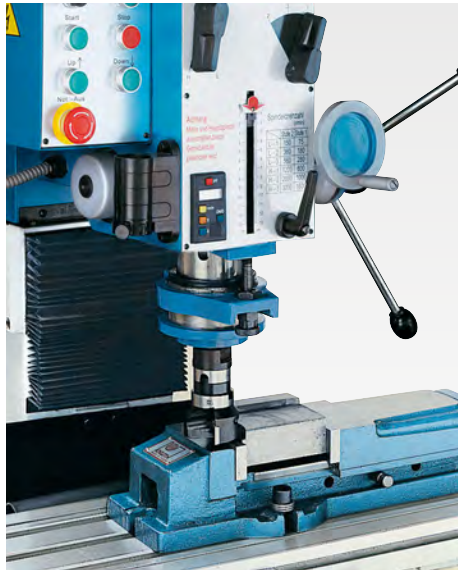
Фрезерование резцовой фрезерной головкой
