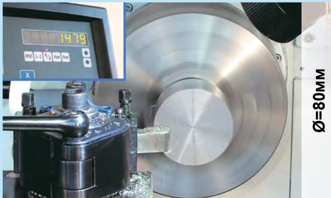
... с помощью автоматически регулируемой частоты вращения шпинделя ...
