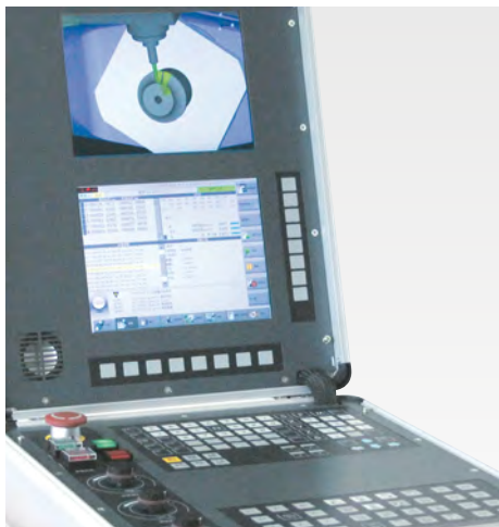
Отдельная система программирования с моделированием в режиме реального времени
