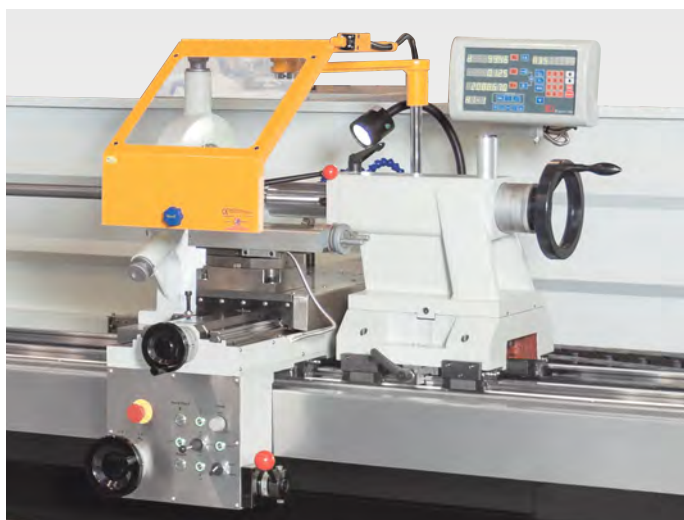
Джойстиковый переключатель подачи и кнопочная электронная установка конечных упоров
