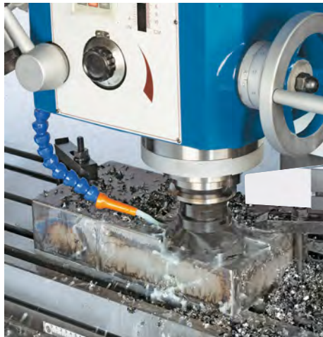
Фрезерование плоской пов. режущей головкой
