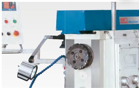
Горизонтальное фрезерование, также с использованием серьги
