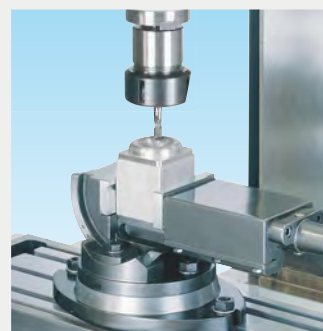
Сверление отверстий до 25 мм
