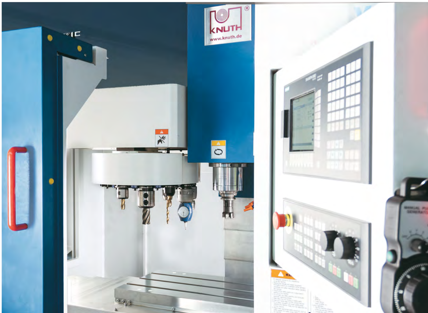
Сменщик инструмента 10-позиционный на X.mill 420 ECO и 12-позиционный на X.mill 640 ECO
