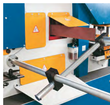
Задний упор с автоматической активацией резки
