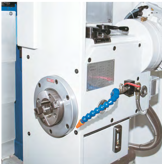
Горизонтальная фрезерная головка (станд. комплектация) с 6-ступенчатой коробкой скоростей
