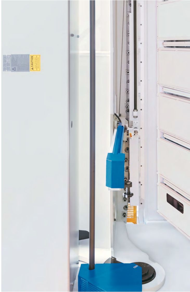
Устройство поддержки листа металла (опция) с моторизованным задним упором и ШВП
