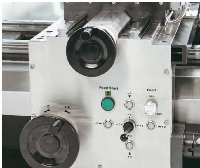
Сервопривод с кнопочным управлением Teach-in может установить конечный упор в соответствующую актуальную позицию
