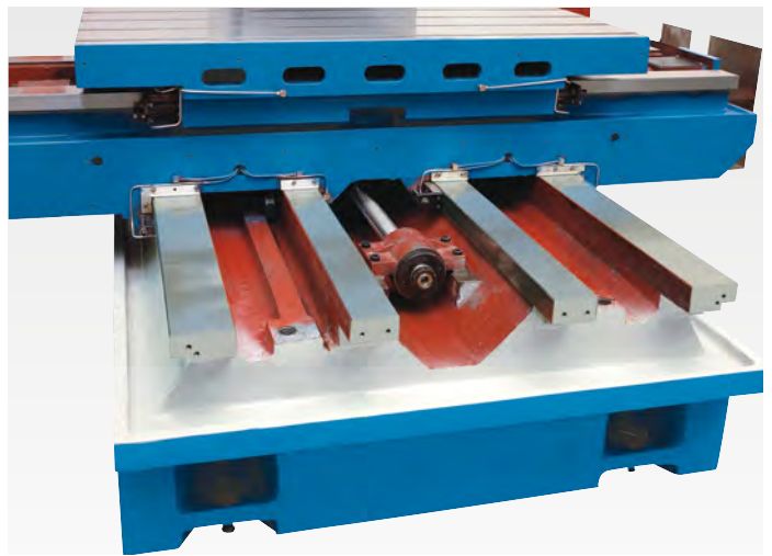
4-полосная система направляющих
