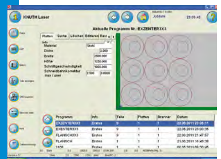
Сетчатый раскрой деталей с врезанием (CAD/CAM - опция)
