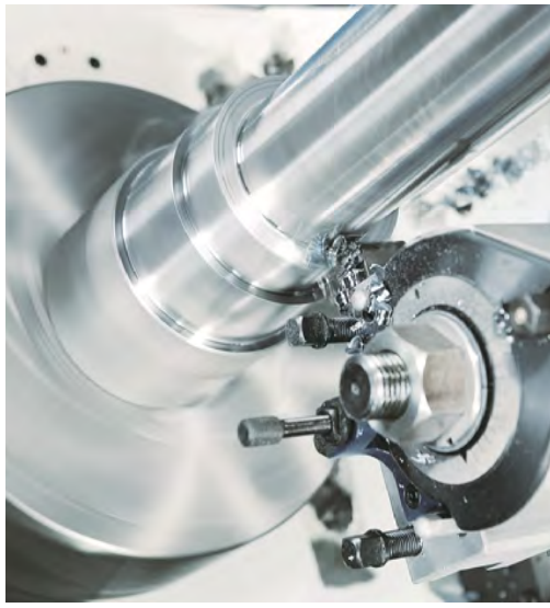
Быстросменный резцедержатель (стандартная комплектация)
