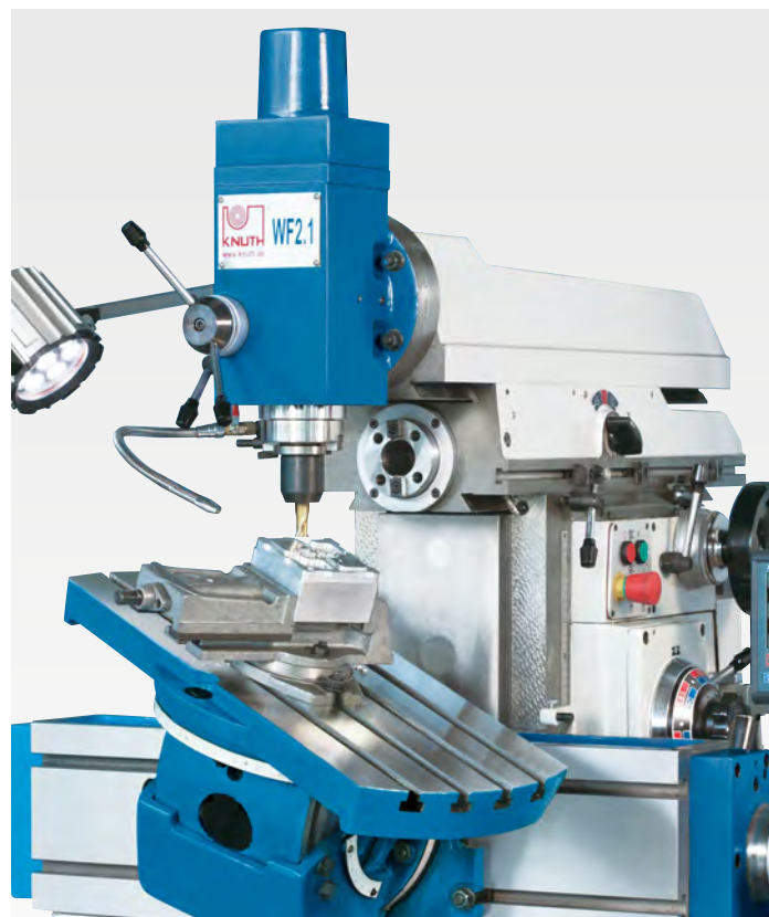
Универсальный поворотный стол (опционально) (изображ. без защитного кожуха)
