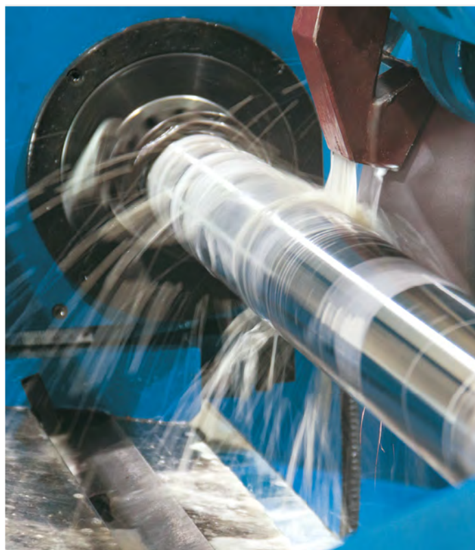
Мокрое шлифование вращающейся заготовки
