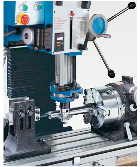
Фрезерование шлицов с делительной головкой
