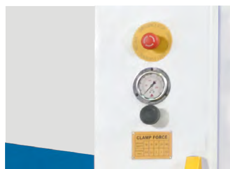
Регулируемое давление зажима верхней траверсы
