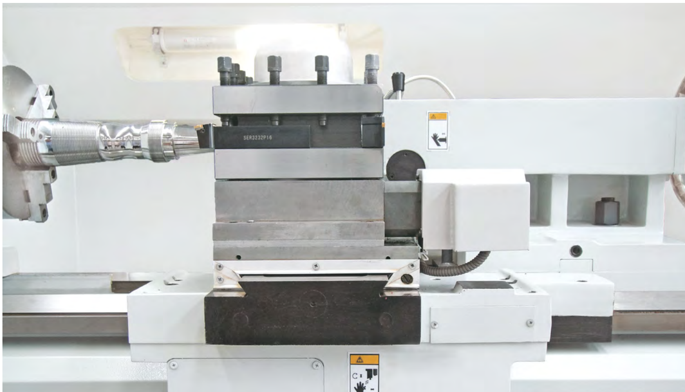
Тяжелая 4-поз. державка инструмента для автоматической смены инструмента
