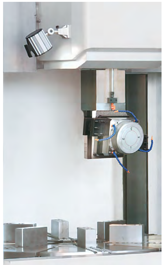
Каждое гнездо инструмента с соплом подачи СОЖ
