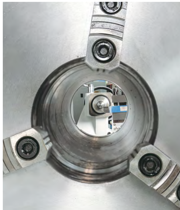
Внутренний Ø шпинделя от 135 до 225 мм
