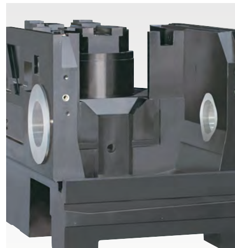
Высококачественная станина из минерального литья
