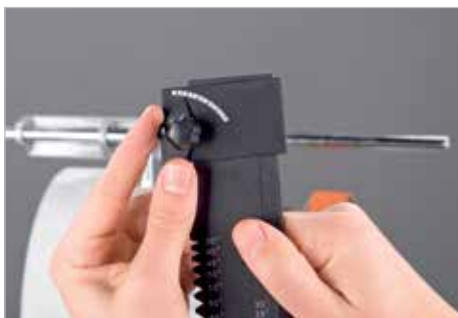
Шаг 2: Настройка измеренного угла лезвия
