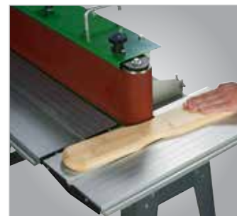
Простое шлифование радиусов с помощью шлифовального вала
