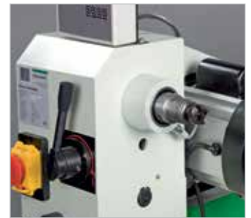
Быстрая и удобная установка скорости шпинделя рукояткой на передней бабке
