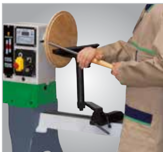
Для точения заготовок большого размера за пределами станины и плоскостного точения передняя бабка станка может поворачиваться на угол до 180°. При этом опора для резца крепится на специальном удлинении станины
