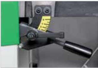
Регулировка высоты снимаемой стружки при фуговании с помощью быстрозажимного приспособления (до 3 мм)
