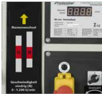
Бесступенчатое регулирование скорости вращения шпинделя в двух диапазонах: 0-1200 об/мин (H) и 0-3200 об/мин (L)
