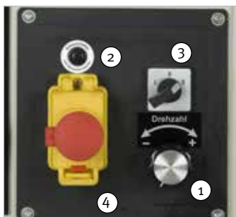
Бесступенчатое регулирование скорости вращения шпинделя в двух диапазонах: 0-1200 об/мин (H) и 0-3200 об/мин (L)
