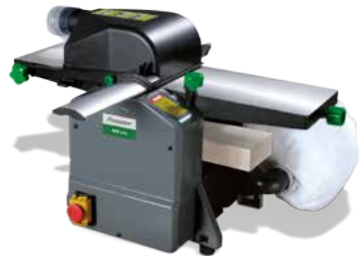
ADH 200 Перестроен для рейсмусования (строгания в заданную толщину)
