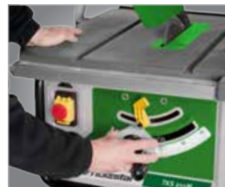
Регулирование угла наклона пильного диска маховиком
