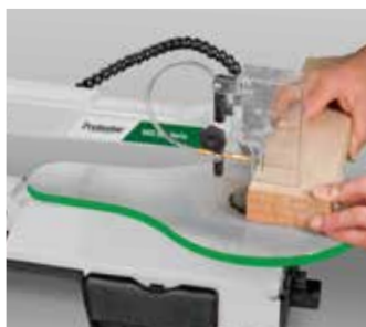
Распил заготовок высотой до 50 мм
