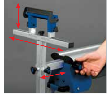
Роликовые блоки регулируются по высоте, в продольном (до 500 мм) и поперечном направлениях
