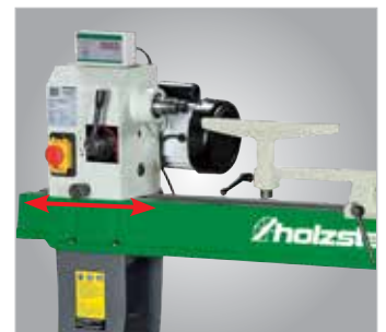
Подвижная передняя бабка DB 1100 с возможностью закрепления в любом месте станины
