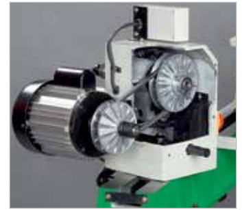
Бесступенчатое регулирование скорости вращения шпинделя 500-2000 об/мин с помощью клиноременного вариатора
