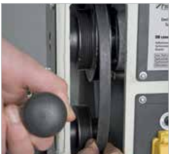
Смена диапазона скорости шпинделя перекидыванием клинового ремня, простое и быстрое натяжение ремня рукояткой
