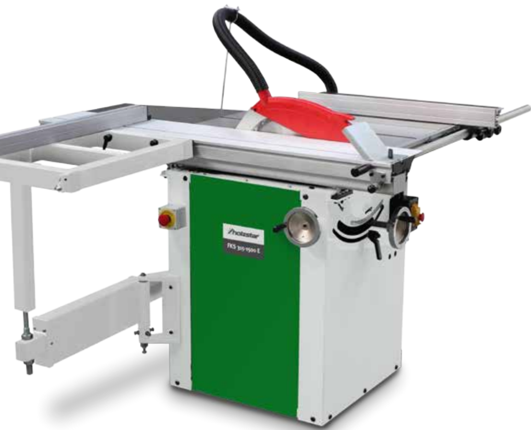
Точный наклон пильного диска на угол от 0° до 45°, производится зубчатым механизмом с поворотной ручкой и шкалой
