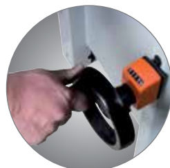
Установка высоты рейсмусования с помощью маховика, очень важно при строгании тонких реек
