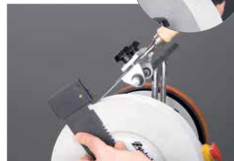
Шаг 3: Настройка подходящей для угла лезвия высоты опорной скобы
