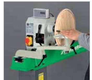
Для точения заготовок большого размера за пределами точения передняя бабка станка может поворачиваться на угол до 180°. При этом опора для резца крепится на специальном удлинении станины
