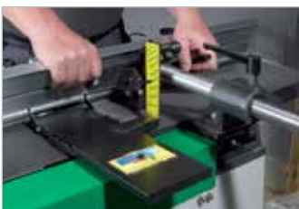
Поворотный на угол от 0° до 45° алюминиевый упор с удобной угловой шкалой
