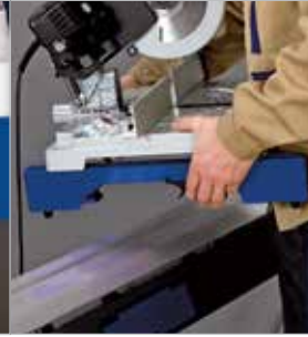
Оборудование может быть установлено на зажимные планки и легко установлено, закреплено и снято с направляющих верстака
