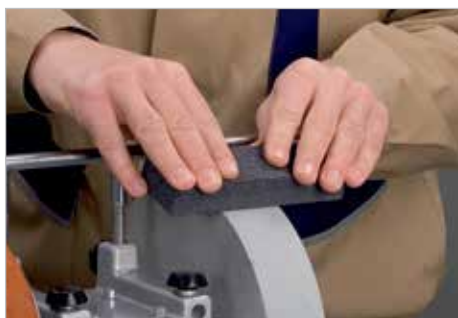
Брусок (грубый/тонкий) для очистки и выравнивания шлиф. круга (Ном. арт. 591 0030)
