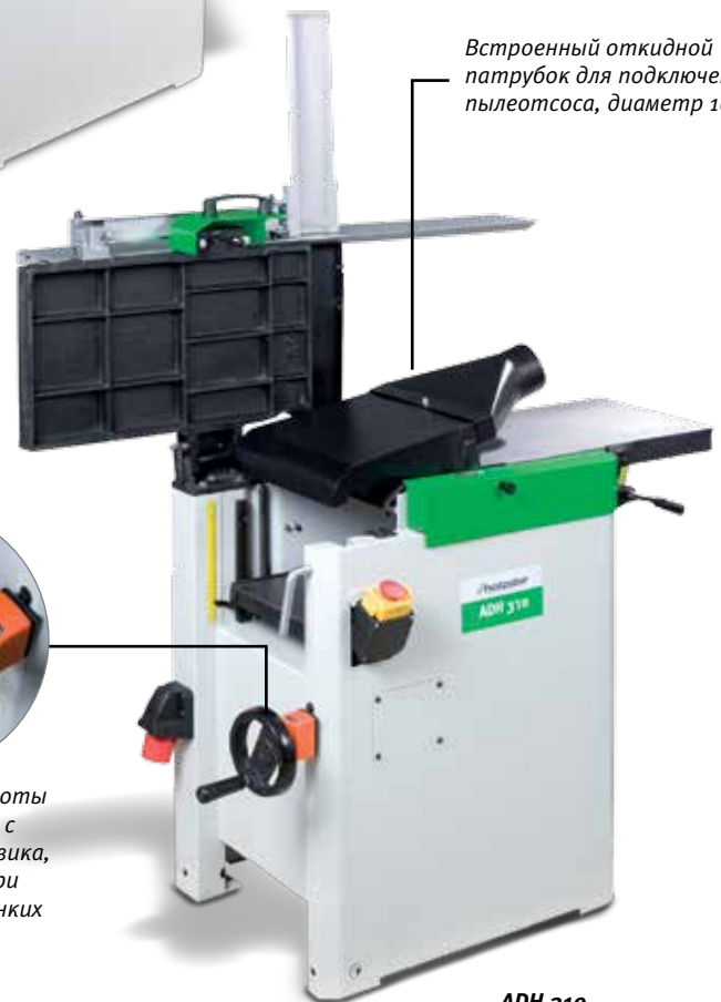
ADH 310 Перестроен для рейсмусования
