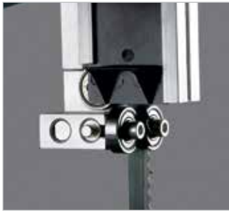
Три точных, долговечных и легко регулируемых опорных ролика пильного полотна
