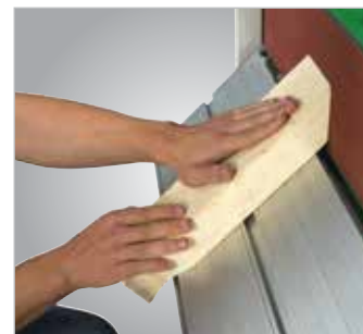
Шлифовка соединения в ус до 45° наклоном продольного стола
