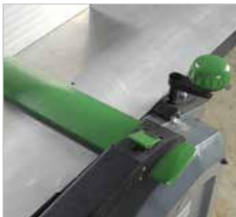
Строгальный вал закрыт защитным кожухом. Толщина снимаемой стружки устанавливается рукояткой и отображается на хорошо читаемой шкале (на рис. ADH 250)
