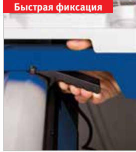
Оборудование может быть установлено на зажимные планки и легко установлено, закреплено и снято с направляющих верстака
