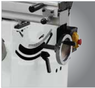
Точный наклон пильного диска на угол от 0° до 45°, производится зубчатым механизмом с поворотной ручкой и шкалой
