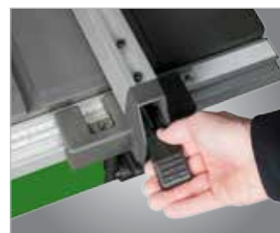
Параллельный упор с эксцентриковым зажимом, точной шкалой и легкой регулировкой
