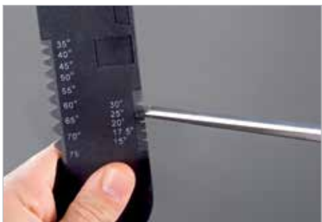
Шаг 1: Проверка и определение угла лезвия
