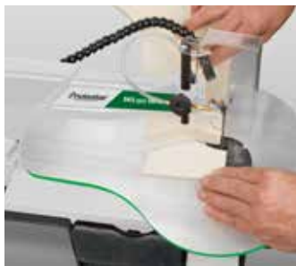
Рабочий стол наклоняется на угол от -45^\circ до 0^\circ . Угол наклона отображается на шкале
