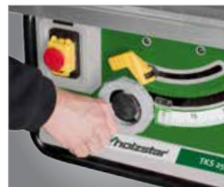
Регулирование высоты пильного диска маховиком
