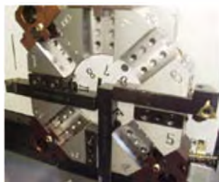
八位伺服刀塔 8-position servo turret
