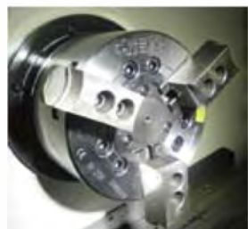
5" 三爪夾頭 5" 3-jaw hydraulic chuck
