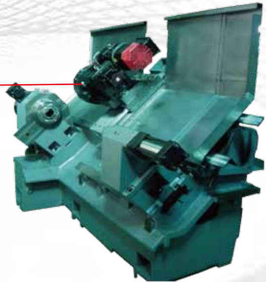
可選配12位置伺服動力刀塔 Opt. 12-position servo power turret.
